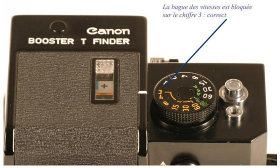
Enclencher le booster. La bonne position n'est pas facile à trouver. Une fois le booster verrouillé tourner sa bague des vitesses jusqu'à ce qu'elle bute sur le 3 orange. Si la bague ne bute pas sur le chiffre 3, démonter , changer la position de la bague des vitesses du boîtier et recommencer. Lorsque le booster est correctement monté :
