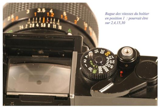
Positionner la bague des vitesses du booster entre le 1 et le 60 blancs (vitesses hautes).
