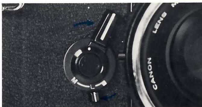
8. Agir sur le sélecteur des vitesses ou la bague du diaphragme jusqu'à placer l'aiguille du posemètre sur le repère noir. Le signe «+» indique la surexposition, le signe «—» la sous-exposition.
