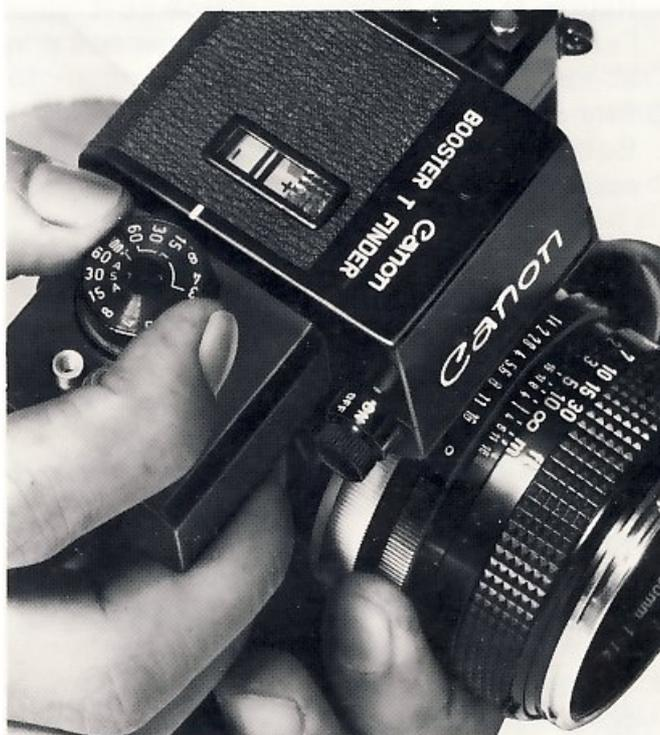
9. Le temps de réponse du posemètre du Viseur Amplificateur T est plus long que celui du posemètre du boîtier, principalement en raison de la faible quantité de lumière. Il sera donc nécessaire d'attendre que l'aiguille se soit stabilisée. Par luminosité extrêmement faible (IL inférieure à zéro) le temps de réponse peut être de 2 à 3 minutes, par luminosité moyenne, il est de 10 à 30 secondes.
