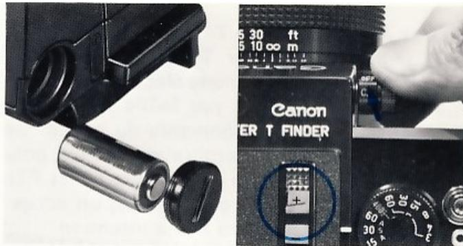
Le Viseur Amplificateur T est alimenté par une pile de 6 V à l'oxyde d'argent, No 544. Pour la mise en place, veillez à ce que le côté positif (+) de la pile soit tourné vers l'extérieur.
