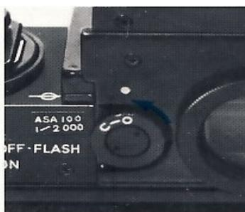
1. Tourner le sélecteur des vitesses sur l'échelle blanche (temps de pose courts). En passant sur le chiffre «3» l'accouplement des deux sélecteurs des vitesses s'effectue automatiquement.
