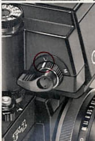
5 Quand l'interrupteur principal est placé en position «M», le circuit de l'Œil Electrique (EE) est débranché et le diaphragme peut être réglé manuellement.
