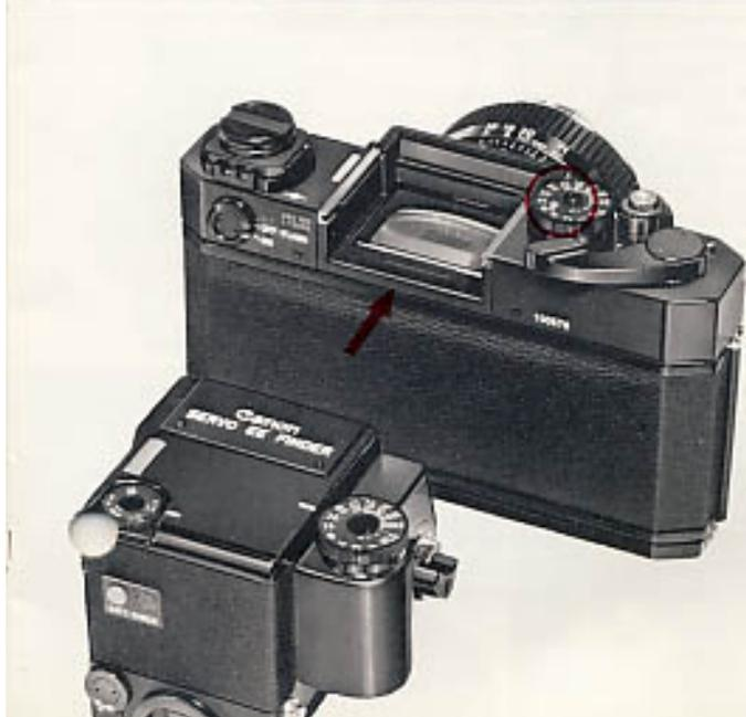
**6** Placez l'échelle de sensibilité du film du Servoviseur EE sur la sensibilité du film utilisé. Pour ce faire, levez et tournez la vis autour du cadran des vitesses d'obturation. Ceci peut être effectué plus facilement si l'on appuie sur le centre du cadran.
