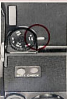
**11** Lorsqu'on tourne le cadran d'ajustement de l'ouverture relative de l'objectif, l'échelle des diaphragmes visible dans la fenêtre à droite du viseur se déplace et l'ouverture relative de l'objectif est alors indiquée juste au-dessous du repère de sous-exposition (en haut).
