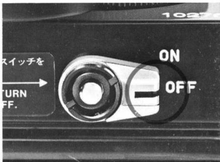
**Remarque:** Lorsque les prises de vues sont terminées, il est nécessaire de remettre l'interrupteur sur «OFF» pour éviter toute consommation inutile de courant. 7
