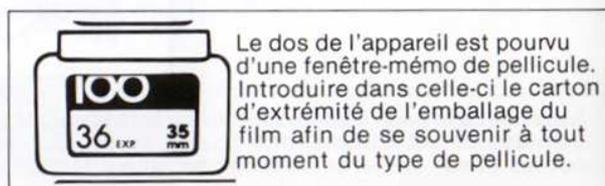
Le dos de l'appareil est pourvu d'une fenêtre-mémo de pellicule. Introduire dans celle-ci le carton d'extrémité de l'emballage du film afin de se souvenir à tout moment du type de pellicule.
