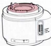
Prendre soin de toujours poser l'objectif face contre table (voir illustration) pour éviter d'endommager les éléments de transmission.
