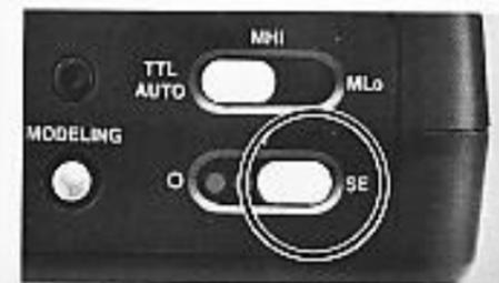
nant, sur le ML-2, nous avons prévu un système de coupure automatique de l'alimentation pour prévenir un éventuel oubli. C'est la position SE (Save-Energy, économiseur de piles). Dans la position SE, si le flash n'entre pas en action durant 5 minutes, l'alimentation est coupée automatiquement.
