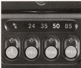
**4** Selon l'objectif utilisé pour le T90, choisir la position correspondante sur l'arrière du flash et s'assurer que l'indicateur de position du zoom est bien allumé pour la position choisie.
