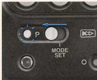
**3** Après avoir placé le sélecteur de mode en position "P", s'assurer que le témoin s'allume, puis placer le commutateur synchro en position avant.
