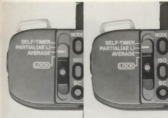
Quel que soit le mode de prise de vue où se trouve l'appareil, un simple déplacement de l'interrupteur principal permet de choisir entre la mesure intégrale à prédominance centrale et celle effectuée sur une zone sélective.
