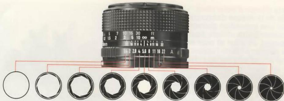
[L'exemple ci-dessus concerne l'objectif FD 50 mm f/1,4. Les ouvertures minimale et maximale diffèrent selon l'objectif]
