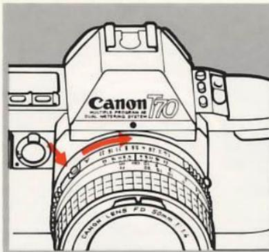
1) Tout en appuyant sur le bouton de blocage EA, tourner la bague du diaphragme à fond dans le sens de la flèche jusqu'à ce qu'elle s'enclenche à la position "A".
