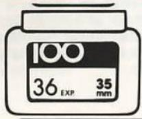
Le dos de l'appareil est pourvu d'une fenêtre-mémo de pellicule. Introduire dans celle-ci le carton d'extrémité de l'emballage du film afin de se souvenir à tout moment du type de pellicule et du nombre de vues dont on dispose.
