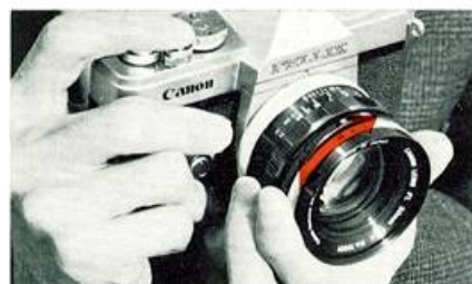
5. Déterminer l'exposition à l'aide de la cellule.
