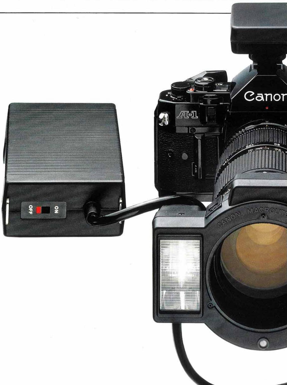
et fait passer la vitesse d'obturation de tout appareil de la gamme A à la vitesse de synchronisation, soit 1/60 s, dès que le flash est chargé. L'alimentation est assurée par huit piles bâton logées dans un boîtier séparé que l'on peut porter en bandoulière ou attaché à la ceinture. Ce boîtier est relié à l'unité de commande par un cordon.
