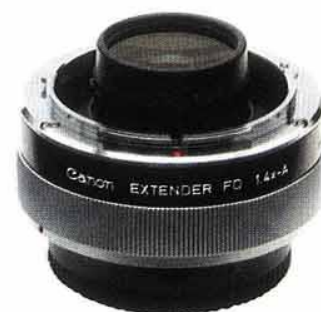
Multiplicateur FD 1,4 × -A Multiplicateur de focale de haute qualité destiné aux téléobjectifs (300 mm et davantage) afin de multiplier leur focale par 1,4. Dans ce cas, la perte de luminosité est de une ouverture seulement. Ce multiplicateur comporte tous les couplages FD et permet donc la mesure à pleine ouverture et l'exposition automatique.
