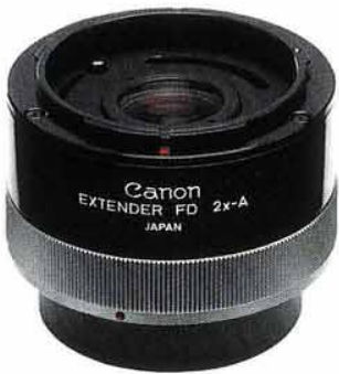
Doubleur de focale FD 2X-A Un système optique de très haut niveau destiné à être placé entre le boîtier et l'objectif pour doubler la focale de ce dernier. Destiné aux objectifs de 300 mm de focale et davantage. Doté de tous les couplages FD. Poids de 210 g à peine.
